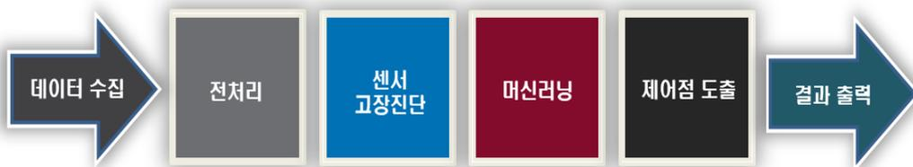
그림 1. 가상센서 계측 및 제어 솔루션 PTOP-Sensor™ 실행 절차
