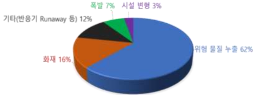
그림 1. 플랜트 산업에서 센서 고장으로 인한 사고
